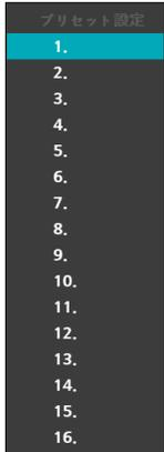
PTZモードでリモコンの**プリセットビュー**ボタンを押して**プリセット移動**ウィンドウが表示されたら、プリセット番号を選択して、その番号に保存された位置にPTZカメラをすぐに移動させることができます。
