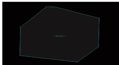
領域設定画面でマウスで希望するエリアを設定できます。設定されたエリアが透明色で表示されます。設定されたエリアの頂点を移動してエリアの変更ができます。エリア設定画面からマウスの右クリックでエリア設定メニューを呼び出すことができます。
