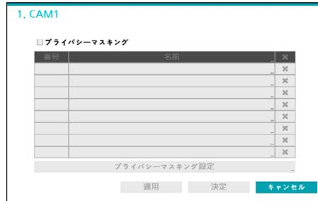
名前を選択すると、設定されたプライバシーマスキングエリアの名前を変更することができます。設定されたプライバシーマスキングエリアは、アイコンを押して個別に削除するか全体を削除します。**プライバシーマスキング設定**を選択すると、エリア設定画面が表示されます。マウスでドラッグしてプライバシーマスキングエリアの大きさを自由に設定することができます。なお、最大16のエリアを追加することができます。
