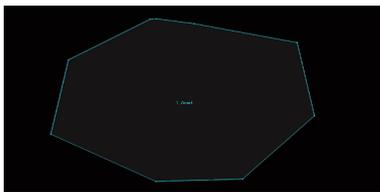
領域設定画面でマウスで希望するエリアを設定できます。設定されたエリアが透明色で表示されます。設定されたエリアの頂点を移動してエリアの変更ができます。エリア設定画面からマウスの右クリックでエリア設定メニューを呼び出すことができます。
