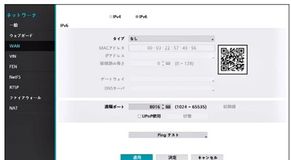
種類をなしに選択して保存すると、IPv6を使用しないように設定されます。
