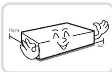
本機の後面には接続のための端子があり、壁に近すぎるところに設置するとケーブルが無理に曲がったり押さえつけられたりして破損する恐れがあります。壁から15cm以上の間隔を開けて設置してください。
