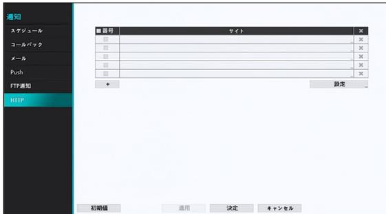
設定ウィンドウの左下にある+ボタンを選択してHTTP通知サーバーの情報を入力します。
