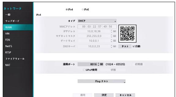
**DHCP**を選択して**適用**を押すと、DHCPサーバーからIPアドレスなどのネットワーク情報を自動的に割り当てられます。ネットワーク情報が割り当てられると、IPアドレス項目にNVRの現在のIPアドレスが表示されます。
