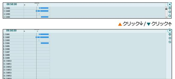
検索ウィンドウ上段に録画された日付/時間情報が表示されます。録画テーブルの赤色の縦の線は現在の再生位置を表します。リモコンの方向ボタンを利用し、現在の再生位置を区間単位で移動することができます。マウスで再生位置を自由に移動させることができます。
