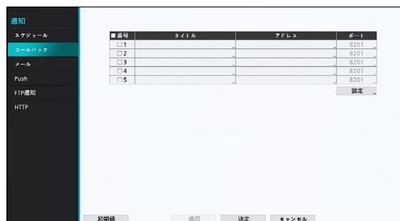
コールバックを受信するサーバーのIPアドレスを設定し、NVRが遠隔接続に失敗したとき、**リトライ**する回数を1回から10回まで選択することができます。
