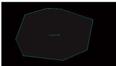
領域設定画面でマウスで希望するエリアを設定できます。設定されたエリアが透明色で表示されます。設定されたエリアの頂点を移動してエリアの変更ができます。
