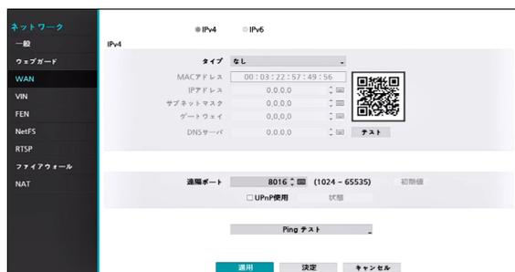
種類をなしに選択して保存すると、IPv4を使用しないように設定されます。
