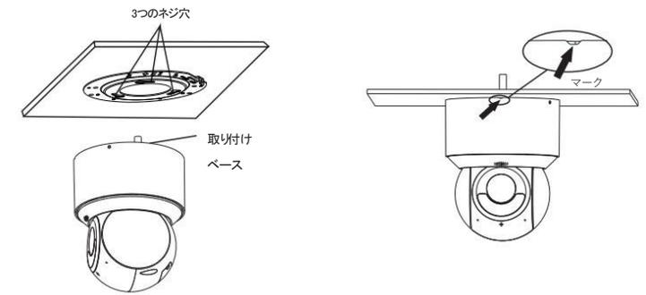
● ジャンクションボックス/ブラケットを使用したカメラの取り付け
