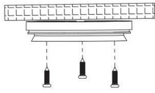
④ドームは最適な視野角を得るため、ドームとエンクロージャーを取り付けベースに取り付けてから調整します。
