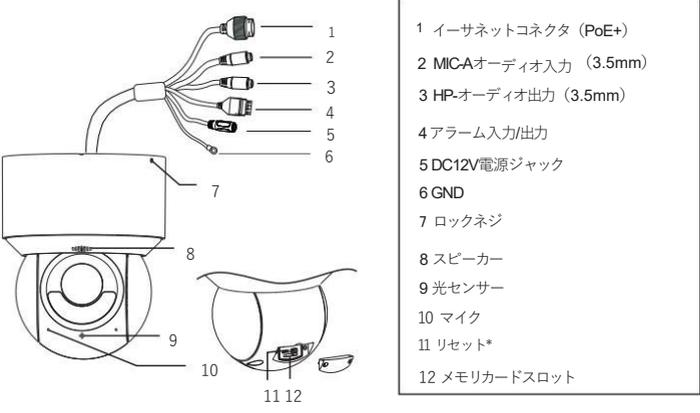
\*リセット: カメラの電源を入れてから、リセットボタンを5秒以上押し続けると、工場出荷時のデフォルト設定にリセットされます。
