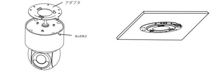
3. アダプターの3つのネジ穴を取り付けベースのネジに合わせ、これらのネジをこれらのネジ穴に挿入します。その後、取り付けベースを時計回りに回してPTZカメラを固定します。
