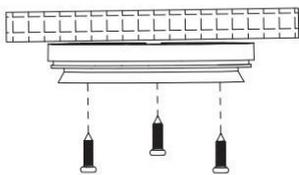
④ドームは最適な視野角を得るため、ドームとエンクロージャーを取り付けベースに取り付けてから調整します。
