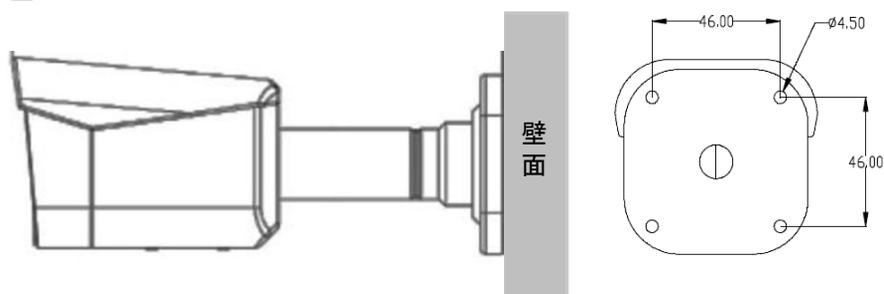
本体ブラケット部分の背面にある4箇所の穴を使用して、確実に固定してください。
