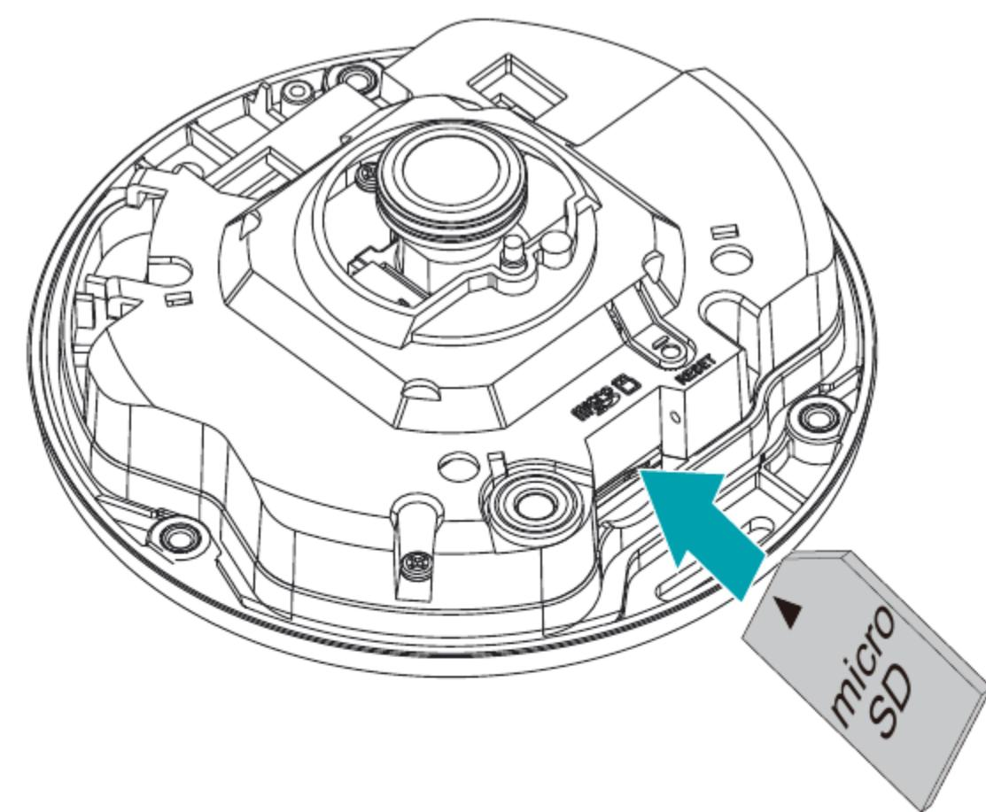
スロットからSDメモリカードを取り外す時は、SDメモリカードの端部分を少し押してください。
