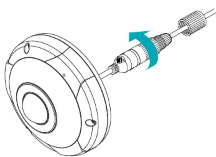
5 防水キャップ本体と栓をRJ45ジャックに押して回転させます。
