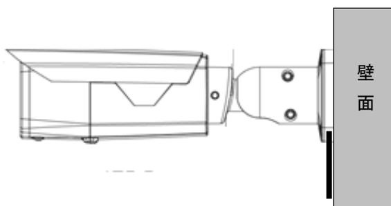
本体ブラケット部分の取付面にある4箇所の穴を使用して、確実に固定してください。
