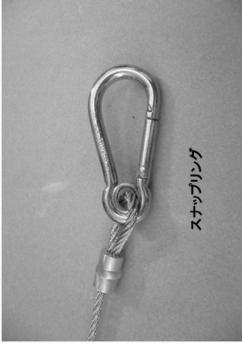
3) 落下防止ワイヤーに付いているスナップリングをアンカーに取付けて下さい。
