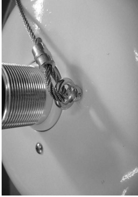
2) サンシールド取付ネジ(M3 x 6)を取外したところに、落下防止ワイヤーの先に付いているアイボルト(M3)を取付けます。
