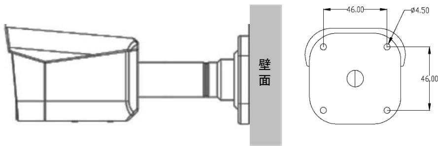
本体プラケット部分の背面にある4箇所の穴を使用して、確実に固定してください。
