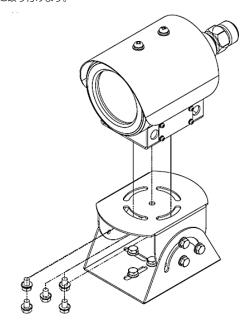
管理可能な監視性能を得るための**台座ブラケット**と**カメラベース** の傾斜位置とパン角度を調整します。
