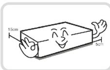
本機の後面には接続のための端子が突出しているため、壁に近すぎると設置するとケーブルが無理に曲がったり押さえつけられたりして破損する恐れがあります。壁から15cm以上の間隔を開けて設置してください。
