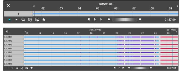
検索ウィンドウ上段に録画された日付/時間情報が表示されます。録画テーブルの縦の線は現在の再生位置を表します。リモコンの方向ボタンを利用し、現在の再生位置を区間単位で移動することができます。マウスで再生位置を自由に移動させることができます。
