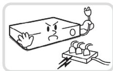
本機が作動するための電源電圧は、電圧の変動範囲が規程電圧の10%以内である必要があります。電源コンセントは必ず接地するようにしてください。電源ケーブルを接続するコンセントには、ヘアドライヤーやアイロン、冷蔵庫などの電熱器具を一緒に使用しないでください。
