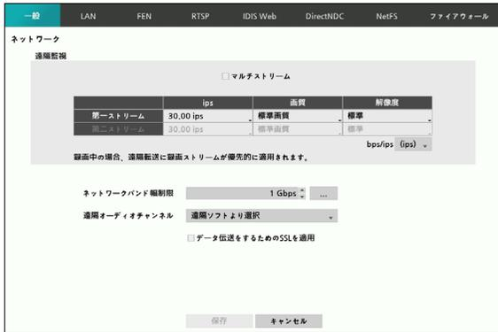
● **マルチストリーム**：ひとつ以上のストリームに対応します。IDIS CenterなどのClientから画面分割モードまたはチャンネルに応じて互いに異なるストリームを使用するように設定することができます。
