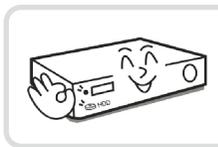
製品前面の録画LEDが点滅し続けていれば、システムとHDDが正常に接続されていることが分かります。
