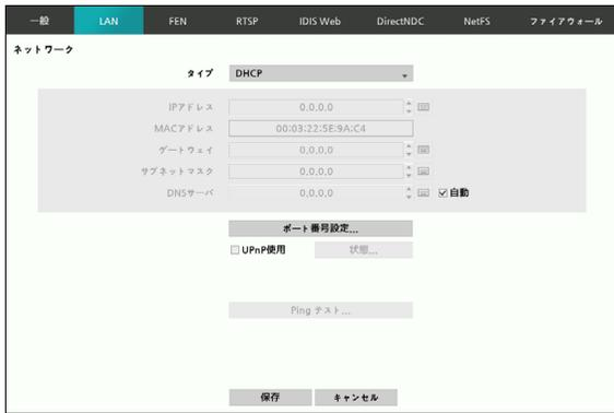
DHCPを選択して適用を押すと、DHCPサーバーからIPアドレスなどのネットワーク情報を自動的に割り当てられます。ネットワーク情報が割り当てられると、IPアドレス項目にDVRの現在のIPアドレスが表示されます。
