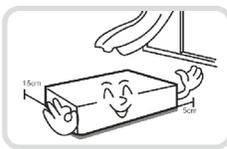
密閉されていない風通しの良い場所に設置し、室内の空気は適切に循環させてください。
