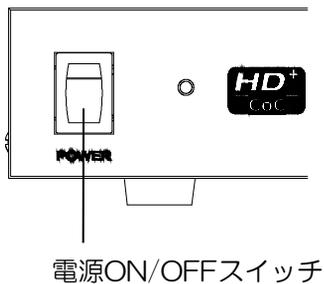
同軸ケーブル、電源コードを接続したら、ONにします。
