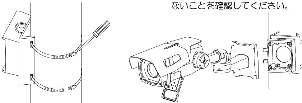
2) 取付けるポール径に適合したステンバンドをポール取付け金具に取付けます。
