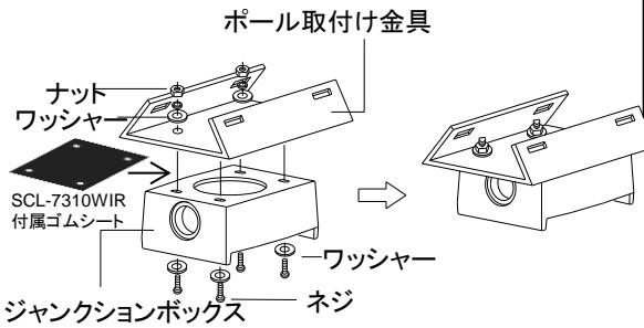
3) 設置するポールに取付けて、ドライバーでステンバンドを締め付けて確実に固定します。
