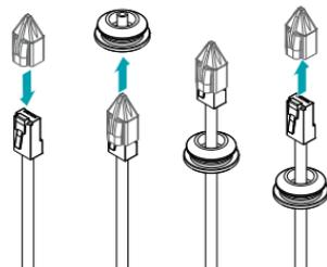
LANケーブルのモールディング部分によって挿入しにくい場合、潤滑剤などを使用して挿入することができます。
