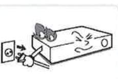
ユーザーが電源プラグを簡単に取り外せる場所に設置してください。
