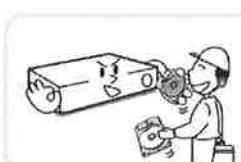
データを保存するHDDの寿命が尽きたと、保存されている映像データが損傷して復旧できないことがあります。HDDに保存されているデータを再生する場合、画面に乱れが生じたらHDDの寿命が尽きたことを意味するため、早急に販売店やサービスセンターに連絡しHDDの交換を依頼してください。
