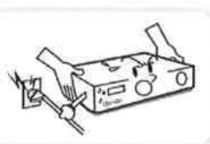
製品の駆動中には電源プラグを抜いたり、製品を動かしたりしないでください。
