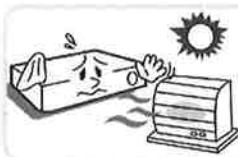
直射光線の当たらない涼しい場所に設置し、適正な温度を維持してください。口ウソクや暖房器具など、熱を発する機器の近くには設置しないでください。
