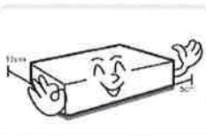
本機の後面には接続のための端子が突出しているため、壁に近すぎるとこころに設置するとケーブルが無理に曲がったり押さえつけられたりして破損する恐れがあります。壁から15cm以上の間隔を開けて設置してください。
