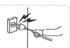
電源ケーブル部分を無理に引き抜いたり、濡れた手で電源プラグに触らないでください。コンセントがゆるい場合は電源プラグを差し込まないでください。
