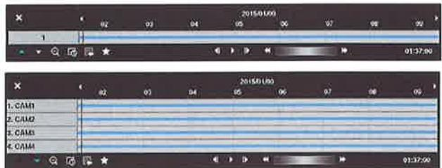
検索ウィンドウ上段に録画された日付/時間情報が表示されます。録画テーブルの縦の線は現在の再生位置を表します。リモコンの方向ボタンを利用し、現在の再生位置を区間単位で移動することができます。マウスで再生位置を自由に移動させることができます。
