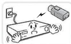
カメラの新規設置および追加工事の前には必ず本機の電源をOFFにし、製品の駆動中には絶対に信号ラインを接続しないでください。
