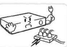
本機が作動するための電源電圧は、電圧の変動範囲が規程電圧の10%以内である必要があります。電源コンセントは必ず接地するようにしてください。電源ケーブルを接続するコンセントには、ヘアドライヤーやアイロン、冷蔵庫などの電熱器具と一緒に使用しないでください。
