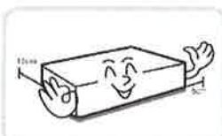
本機の後面には接続のための端子が突出しているため、壁に近すぎるところに設置するとケーブルが無理に曲がったり押さえつけられたりして破損する恐れがあります。壁から15cm以上の間隔を開けて設置してください。
