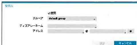
使用を選択して追加したメールアカウントの使用可否について選択した後、受け取る人が属している受信者グループを選択します。表示名を選択して受信者の表示名をした後、アドレス項目に受信者のメールアドレスおよびメールサーバーを設定します。★を選択すると登録されたメールサーバーリストから希望するメールサーバーを選択することができます。
