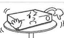
水平で安定した場所に設置し、垂直に立てたり斜めに置いて使用しないでください。
