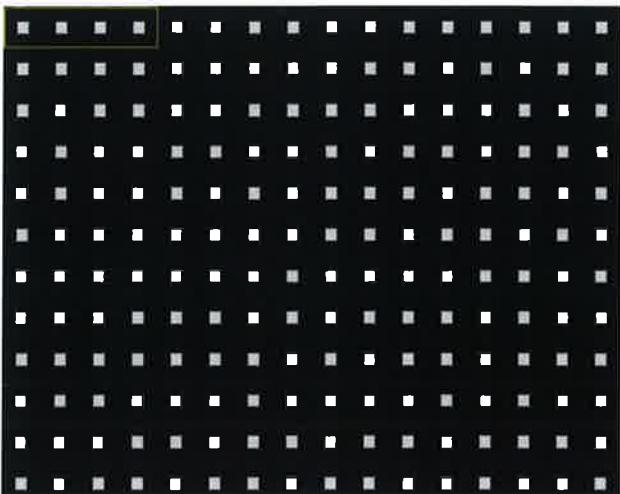
エリア設定画面でリモコンの方向ボタンを利用し、ブロック単位のエリア選択ウィンドウを上下左右に移動することができます。選択ウィンドウは4つのブロックの大きさの1列に該当し、**カメラ**ボタンで各ブロックを選択／解除することができます。マウスを利用してエリアをドラッグしたあと、選択／解除／反転させることができます。
