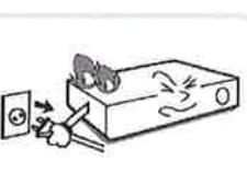
ユーザーが電源プラグを簡単に取り外せる場所に設置してください。
