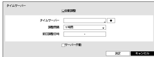
“自動調整”項目を選択してから、“タイムサーバー”的IPアドレスかドメイン名を入力したり★を選択して登録されたタイムサーバーリストよりご希望のタイムサーバーを選択して、“調整間隔”を設定すると、調整間隔毎にタイムサーバと時間を同期するようになります。“前回調整日時”項目は、最後に同期の行われた時間を表示します。
