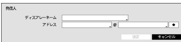
“ディスプレーネーム”を選択し、発信人の表記ネームを指定した後、“アドレス”項目で、発送人のメールアドレス及び、メールサーバーを設定します。★を選択すると、登録されたメールサーバリストから、希望するメールサーバの選択ができます。
