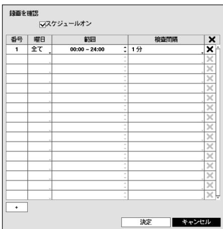
“スケジュールオン”を選択してから曜日、時間範囲及び検査間隔を設定します。設定画面左下の“+”を押すと、新しいスケジュールが追加されます。Xを選択すると検査スケジュールを削除することができます。
