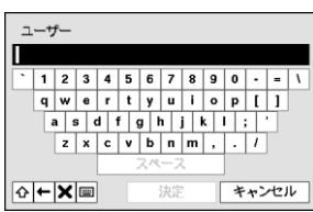
矢印ボタンを利用して任意の文字に移動して?ボタンを押すか、矢印を合わせてマウスをクリックすると、文字が入力されます。▲ボタンは大文字と小文字を設定し、←はカーソルの前の文字を、×はカーソルの後の文字を消します。[ ]ボタンはキーボードの配列を変更します。タイトルは空スペースを含めて最高31字まで入力できます。^を選択してから<sup>^</sup>を入力すると、コントロール文字を入力できます。例えば、<sup>^J</sup>はNL(New Line)、<sup>^M</sup>はCR(Carrage Return)として認識されます。これはテキストイン検索設定時に使用されます。
