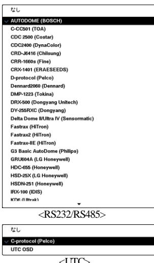
“モデル”を選択すると、PTZカメラのタイプを選択しIDを選択すると、該当カメラをPTZモードで操作することができます。
