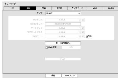
“タイプ”で“DHCP”を選択した場合、DHCPでネットワークに接続されているDVRのネットワークの設定ができます。“保存”を選択するとDHCPサーバーからIPアドレスなどのネットワーク情報を自動で受け入れます。ネットワーク情報を受け入れるとIPアドレスの項目にDVRの現在IPアドレスが表示されます。
