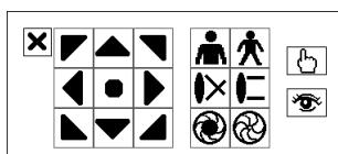
PTZ制御ボックスの[X]をクリックするとPTZ制御ボックスが消えます。アイコンの下をクリックしてからドラッグ&ドロップしてボックスの位置を変更できます。矢印アイコンをクリックしてPTZカメラを上/下/左/右などの8個方向に移動させることができます。各アイコンの機能は下記の通りです。
