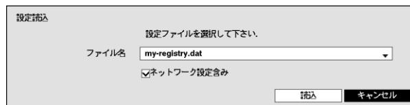
“ファイル名”で設定ファイルを選択してから“読み込む”ボタンを選択します。この時、ネットワーク設定も共に読み込むかを選択できます。“ネットワーク設定含み”を選択しないとDVRのネットワーク設定は変更されません。
