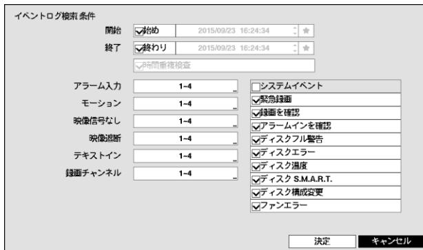
“開始”で“始め”を選択すると、保存されたデータのうち最初の時刻で設定され、“終了”で“終わり”を選択すると、保存されてデータのうち最後の時刻で設定されます。“始め”や“終わり”的チェック表示を外すと、検索する期間を直接変更できます。■を選択すると選択したブックマークの時点を開始または終了時間に設定できます。
