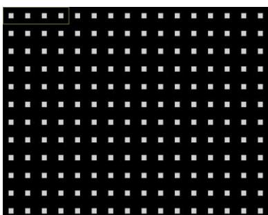
エリア設定画面で矢印ボタンを利用して、ブロック単位のエリア選択画面を上下左右に移動させます。選択画面は4個のブロックサイズの一列に該当します。カメラボタンで各ブロックを選択/解除できます。エリア設定モードで④ボタンによってエリア設定メニューを呼び出して選択することができます。
