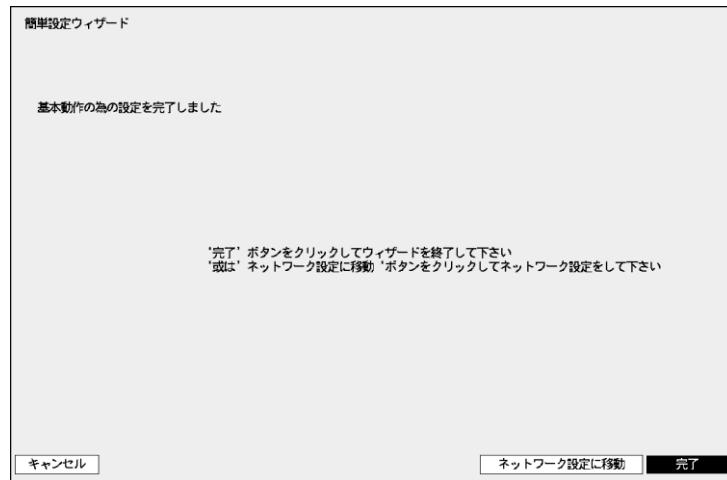
“完了”を選択すると簡単設定ウィザードを完了します。“ネットワーク設定に移動”を選択するとネットワーク設定ウィザードを始めます。
