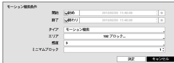
“開始”で“始め”を選択すると、保存されたデータの最初の時刻で設定され、“終了”で“終わり”を選択すると、保存されたデータの最後の時刻で設定されます。“始め”や“終わり”的チェック表示を外すと、検索する期間を直接設定できます。★を選択すると選択したブックマークの時点を開始または終了時間に設定できます。
