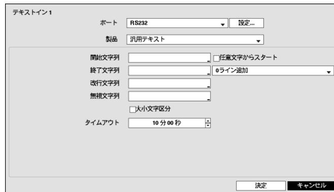
ポートをRS232、RS485、USB-Serial 1~8、LAN 1~4の中でひとつを選択する場合、ポート設定ボタンが活性化します。“設定”ボタンを押して“ボーレート”、“データ長”、“ストップビット”、“パリティー”値を正しく設定してください。
