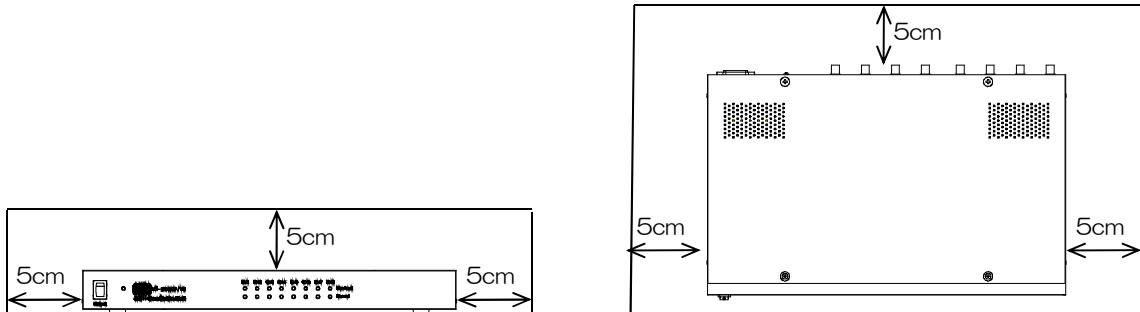
■本機を積み重ねた状態では設置しないで下さい。熱がこもり、誤動作・故障の原因となることがあります。やむをえず積み重ねる場合、同梱のゴム脚を各機の間にはさみ、間隔を空けるようにして下さい。
