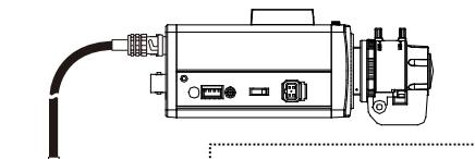
本機のカメラ接続端子に、電源重畠方式対応のカメラをBNC端子の同軸ケーブルで接続します。
