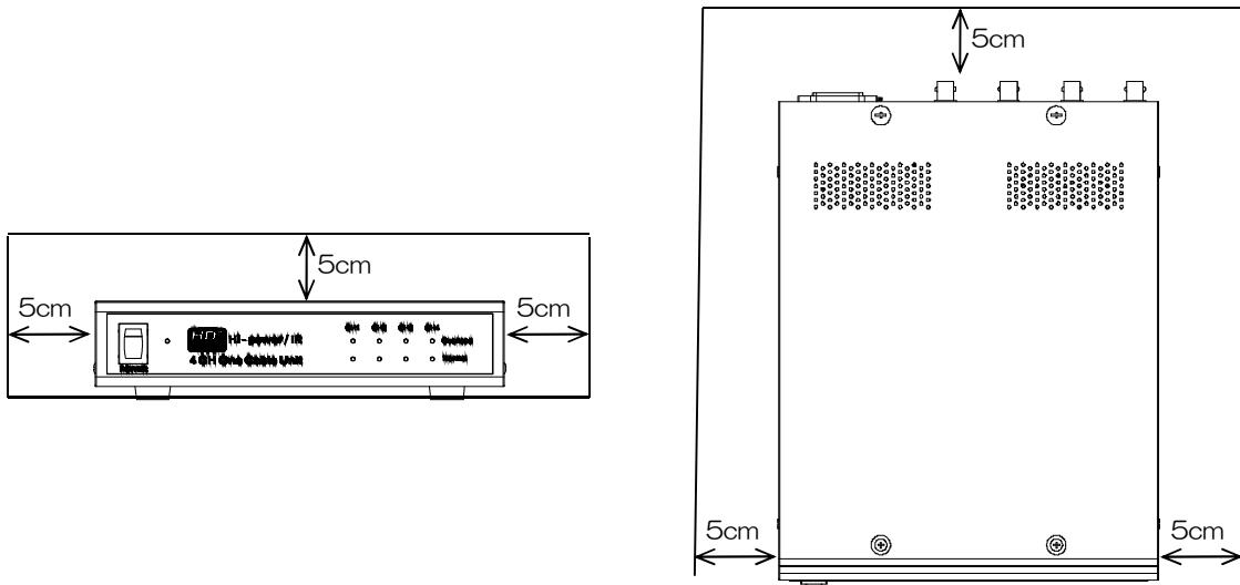
■本機を積み重ねた状態では設置しないで下さい。熱がこもり、誤動作・故障の原因となることがあります。やむをえず積み重ねる場合、同梱のゴム脚を各機の間にはさみ、間隔を空けるようにして下さい。
