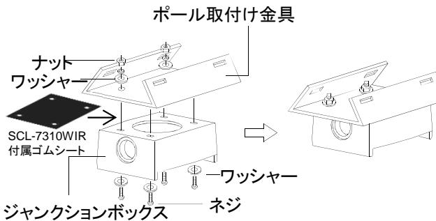
3) 設置するポールに取付けて、ドライバーでステンバンドを締め付けて確実に固定します。
