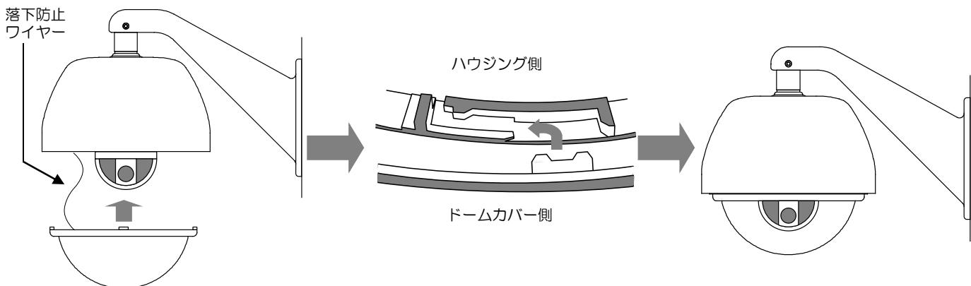
※落下防止ワイヤーを外した状態で設置作業を行った場合、ドームカバーを取り付ける際には必ず落下防止ワイヤーを取り付けるようにしてください。
