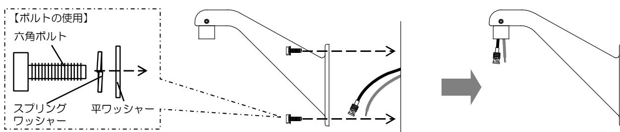
※壁付けブラケットと壁面が接する部分についてはコーティングをして下さい。雨水や虫、ホコリ等が侵入する原因となります。
