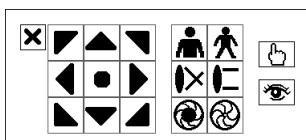
PTZ制御ボックスの $\times$ をクリックするとPTZ制御ボックスが消えます。アイコンの下をクリックしてからドラッグ&ドロップしてボックスの位置を変更できます。矢印アイコンをクリックしてPTZカメラを上/下/左/右などの8個方向に移動させることができます。各アイコンの機能は下記の通りです。
