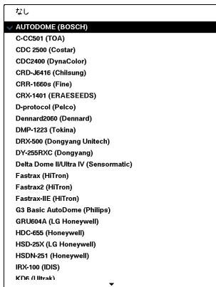
“モデル”を選択すると、PTZカメラのタイプを選択しIDを選択すると、該当カメラをPTZモードで操作することができます。
