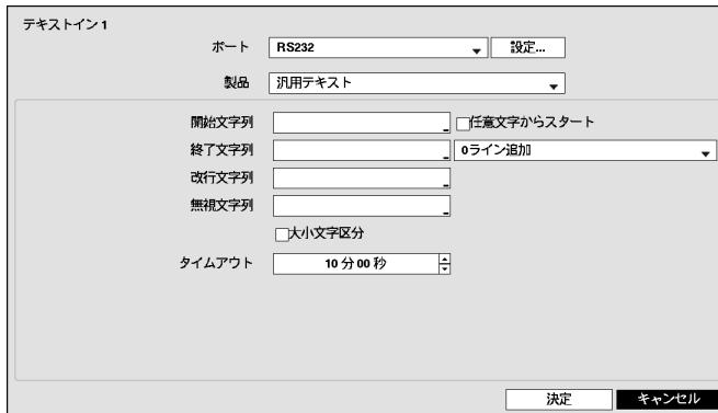
ポートをRS232、RS485、USB-Serial 1~8、LAN 1~4中でひとつを選択する場合、ポート設定ボタンが活性化します。“設定”ボタンを押して“ボーレート”、“データ長”、“ストップビット”、“パリティ”値を正しく設定してください。
